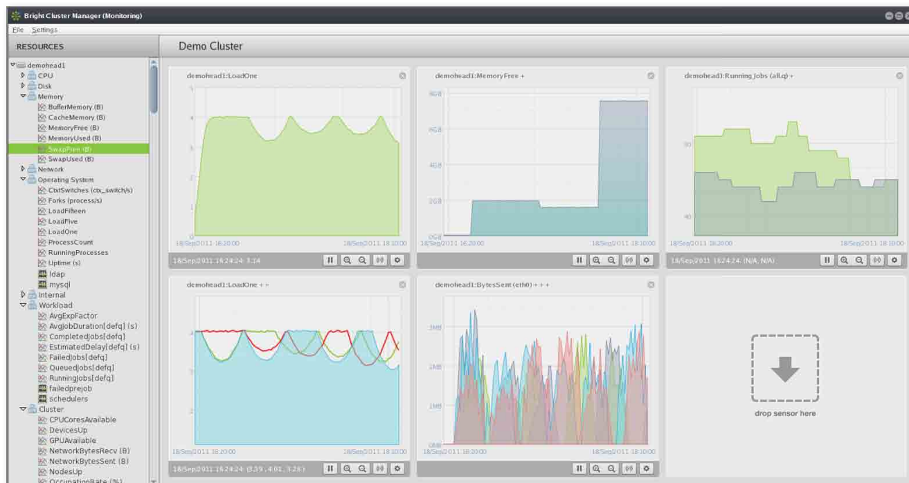
LES STATISTIQUES CLUSTER TELLES QUE TEMPÉRATURE GPU ET CPU, VITESSE DES VENTILATEURS ET STATS RÉSEAU PEUVENT ÊTRE VISUALISÉES PAR UN SIMPLE GLISSER-DÉPOSER DE LA LISTE À GAUCHE VERS LA FENÊTRE DE GRAPHIQUES À DROITE. IL EST POSSIBLE DE COMBINER PLUSIEURS STATISTIQUES DANS UN GRAPHIQUE ET D'AGRANDIR LA VUE. VOUS POUVEZ ADAPTER LA MISE EN PAGE ET LES COULEURS DES GRAPHIQUES À VOS EXIGENCES.
